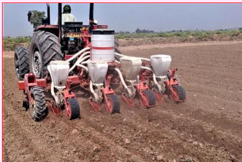
شکل ۴- کاشت سویا با ردیف‌کار مجهز شده به ضمیمه جدید پاشش مستقیم مایه تلقیح روی بذر در خاک
