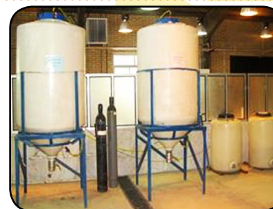
فناوری نگهداری بذور خودمصرفی زارعین با استفاده از اتمسفر کنترل شده در مخازن کوچک
