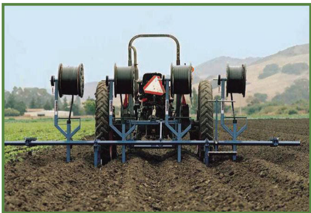
شکل ۲۲- نصب مکانیزه نوار آبیاری قطره‌ای
