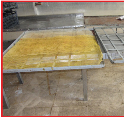
شکل ۴- سینی های مخصوص خشک کن کابینتی
