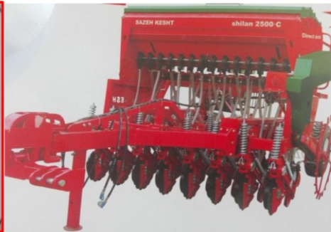
ج) بذر کار - کود کار (کشت مستقیم) مدل Shilan 2500 C
