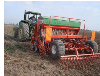
شکل ۳- بذرکار بی خاک‌ورزی با شیار بازکن‌های بشقابی کنگره دار
