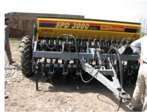
شکل ۲- بذرکار بی خاک‌ورزی با پیش‌بر بشقابی صاف و شیار بازکن دو بشقابی
