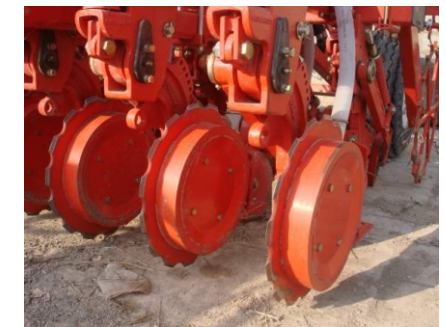
شکل ۳- بذرکار بی خاک‌ورزی با شیار بازکن‌های بشقابی کنگره دار
