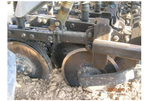
شکل ۲- بذرکار بی خاک‌ورزی با پیش‌بر بشقابی صاف و شیار بازکن دو بشقابی
