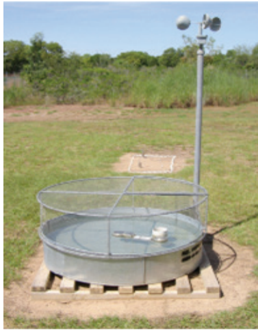
شکل ۳- نمایی از تشتک تبخیر و محل نصب آن
