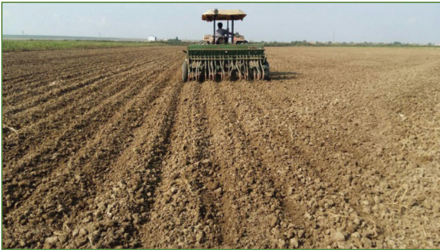
شکل ۲- خطی کار همدانی: ابزار متداول برای کاشت کلزا در مغان
