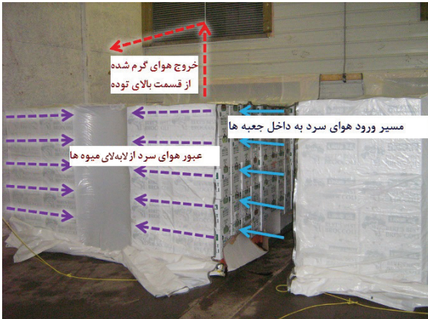
شکل ۱۵- روش سردکردن اولیه میوه تازه برداشت شده با
