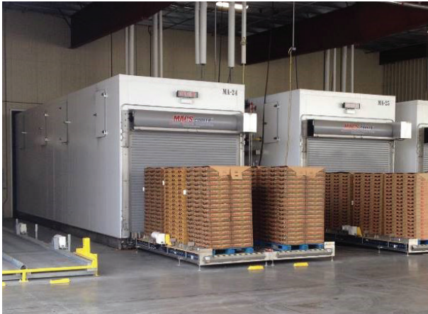
شکل ۱۴- سیستم سردکننده تونلی میوه ها و جعبه های آماده ورود به تونل های سردکننده
