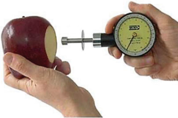
شکل ۴- روش انجام آزمون سفتی بافت با دستگاه سفتی سنج دستی
