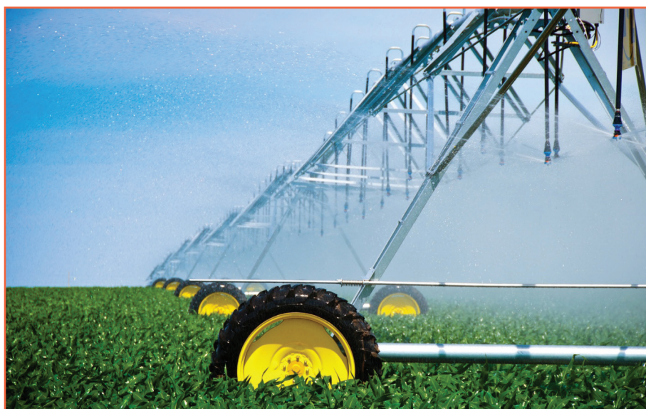
شکل ۷- سامانه آبیاری لینیر
