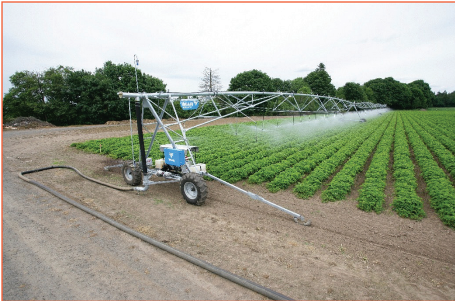
شکل ۸- سامانه لینیر در حال کار در مزرعه
