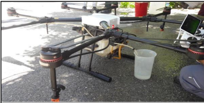
شکل ۳- اندازه گیری بده پمپ
