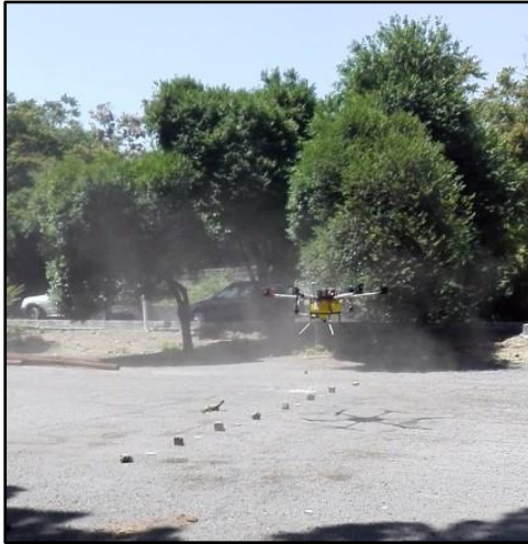
شکل ۱- روش اندازه‌گیری عرض کار مؤثر پهپادسمپاش
