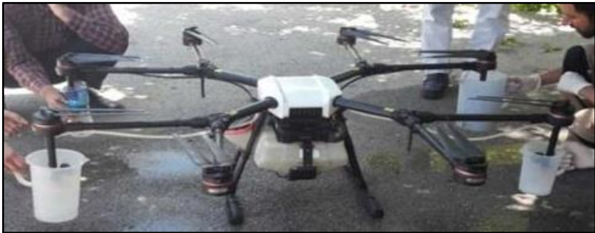
شکل ۴- اندازه‌گیری بده افشانک‌ها
