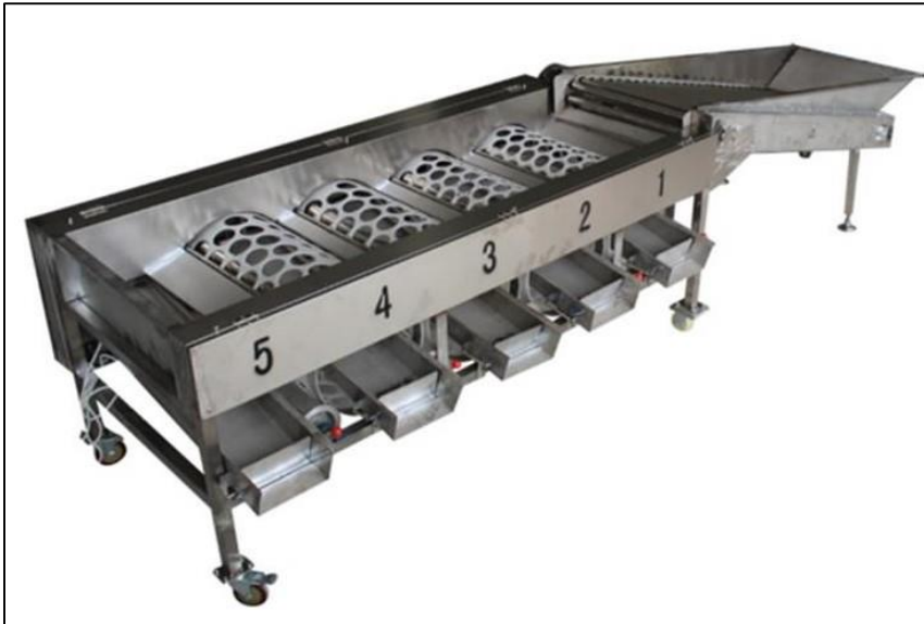
شکل ۶- نمونه‌ای از سورت پیاز زعفران با سازو کار سرندهای دورانی متوالی
