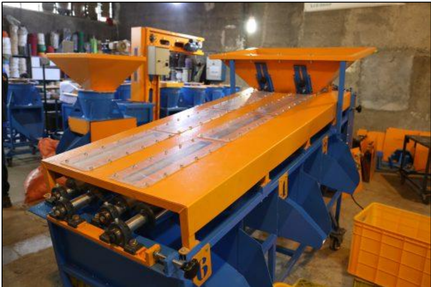
شکل ۹- سورت‌ر پیاز زعفران مبتنی بر غلتک‌های واگرا
