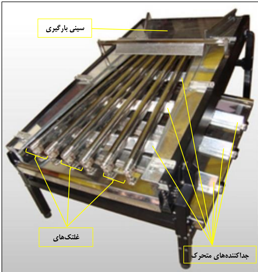
شکل ۸- نمونه‌ای از سورتر مبتنی بر غلتک‌های واگرا
