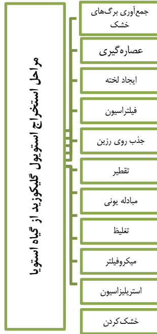
شکل ۶- مراحل استخراج استویول گلیکوزید از گیاه استویا
