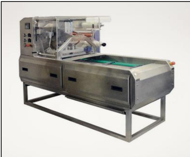
شکل ۱- نمونه‌ای از دستگاه پرکردن یا گاز زدن سریع در روش MAP
