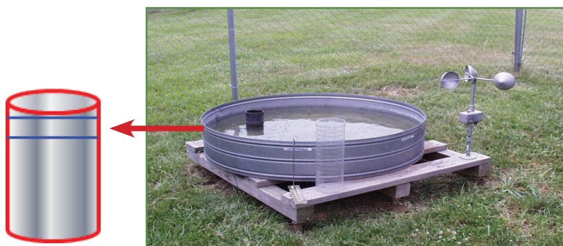
شکل ۵- نمایی از تشت تبخیر و اجزای آن (تشت، استوانه کوچک درون تشت و پیمانه)
