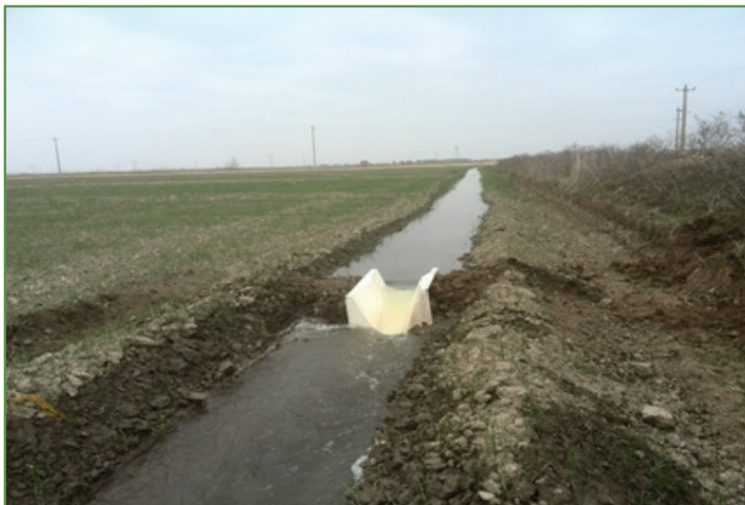
شکل ۷- نمایی از نحوه اندازه‌گیری دبی آب ورودی به مزرعه با استفاده از فلوم دوزنقه‌ای
