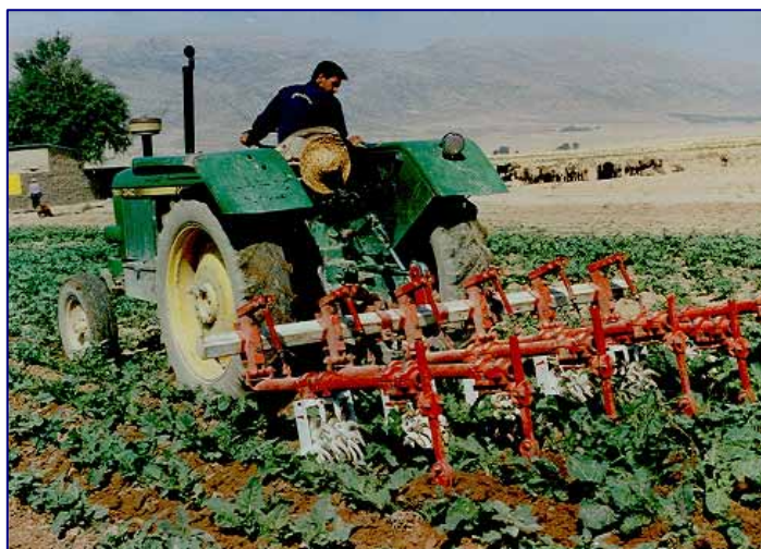
شکل ۳- کولتیواتور چرخان ( غلتان) در حال کار
