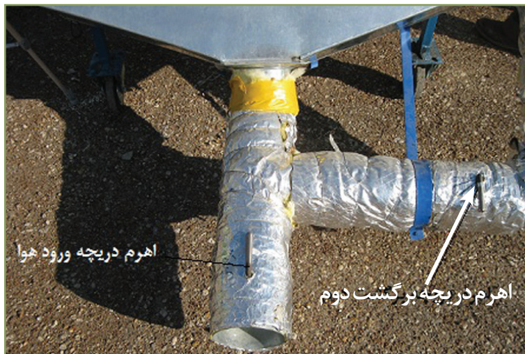
شکل ۱۵- دریچه‌های ورود هوا و برگشت هوای دوم
