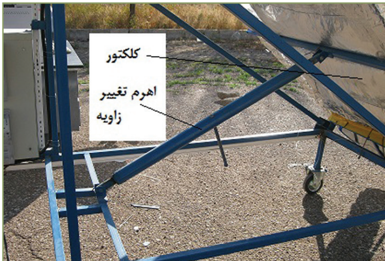
شکل ۱۱- اهرم تغییر زاویه شیب کلکتور در خشک‌کن خورشیدی
