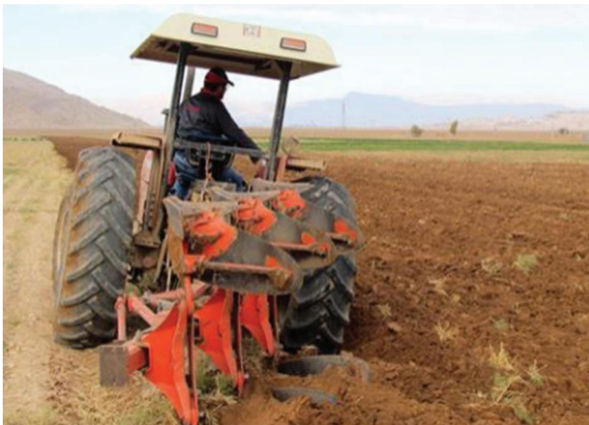
شکل ۴- تشکیل نشدن کلوخه به هنگام شخم زدن در رطوبت مناسب خاک (۱۴ تا ۱۷ درصد)
