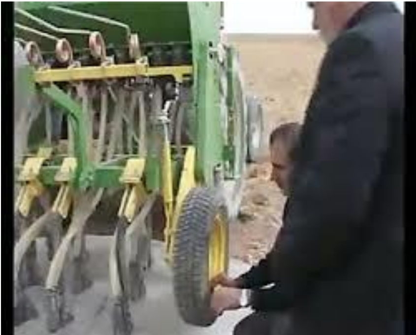
شکل ۱۲- کالیبره کردن کارنده به روش آزمایشگاهی
