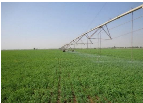
شکل ۵- استفاده از لولهٔ عصایی در سامانهٔ بارانی عقربه‌ای برای کاهش تبخیر و بادبردگی
