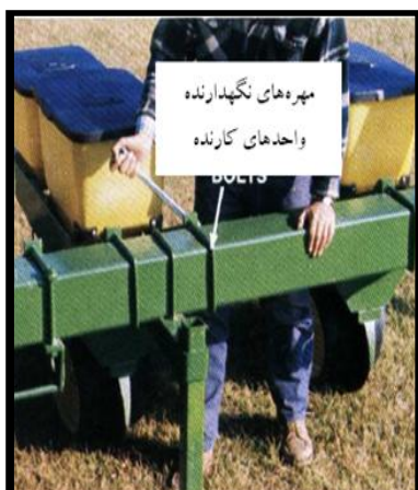
شکل ۱۰- شل کردن مهره‌های نگهدارنده جهت تنظیم فاصله ردیف‌ها
