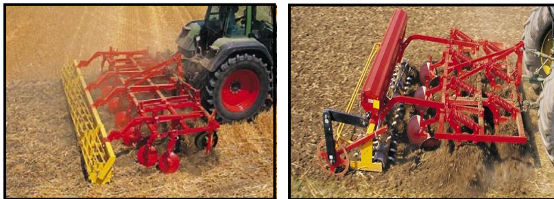
شکل ۷- نمونه خاک‌ورز مرکب (چیزل با تیغه‌های پنجه‌غازی + دیسک + غلتک)
