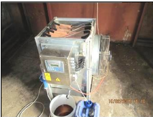
شکل ۵- دستگاه ثابت تزریق کلروپروپام و دیگر محلول‌ها در انبار سیب زمینی
