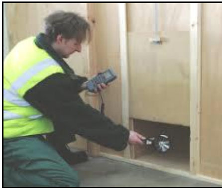
شکل ۱۰- کنترل یکنواختی جریان هوا در کانل‌های هوا به کمک دستگاه بادسنج قابل حمل
