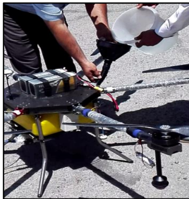
شکل ۱۸- واسنجی بده خروجی پهپادسمپاش
