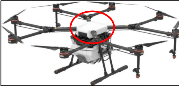
شکل ۸- واحد خنک کننده داخلی پهپادسمپاش
