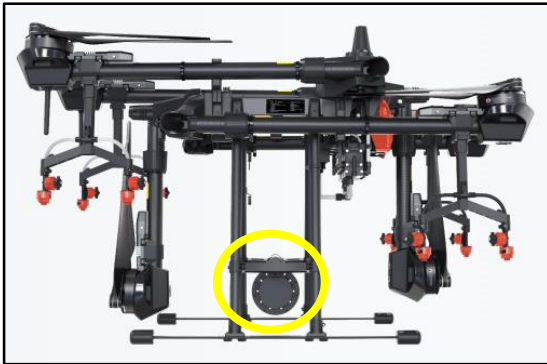
شکل ۱۱- حسگر راداری نصب شده زیر پهپادسمپاش
