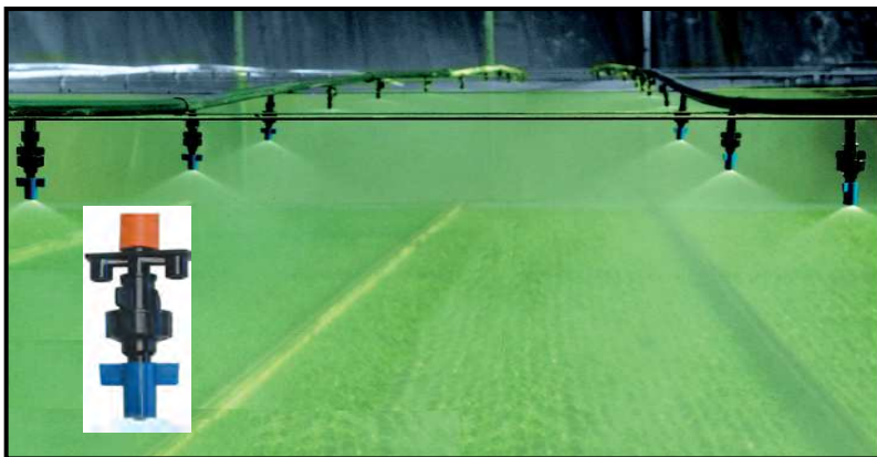
شکل ۱۰- ایجاد سرما با استفاده از سیستم مه پاشی
