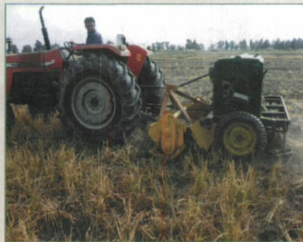
شکل ۲- ترکیب خاک‌ورز نواری و خطی کار غلات در حال کاشت گندم در بقایای برنج
