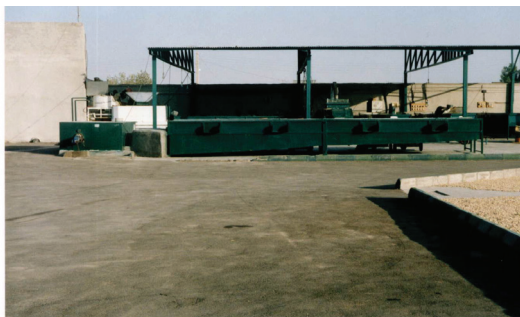
شکل ۸- نمونه ای از خشک کن وعده ای (بستر ثابت خوابیده)
