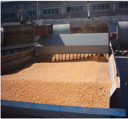
شکل ۱۰- خشک کن های وعده ای ذرت دانه ای مجهز به سیستم همزن
