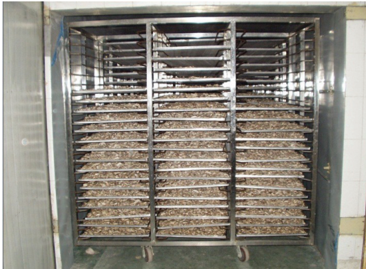
شکل ۲۳- ساختار نمونه‌ای از خشک‌کن تونلی مورد استفاده
