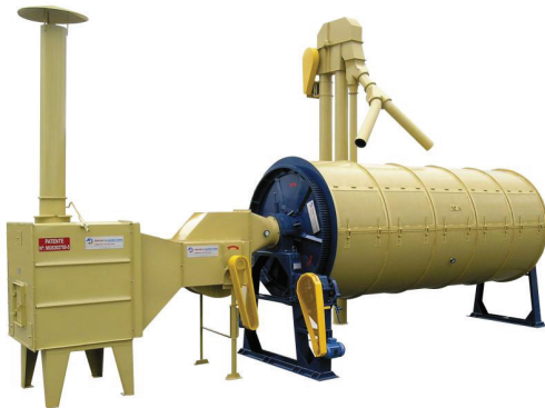
شکل ۱۸- نمونه ای از خشک کن دوار مورد استفاده برای خشک کردن محصولات دانه ای
