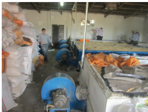
شکل ۱۱- انواع خشک کن های خوابیده وعده ای با بدنه فلزی (تصویر راست) و سیمانی (تصویر چپ) برای خشک کردن شلتوک
