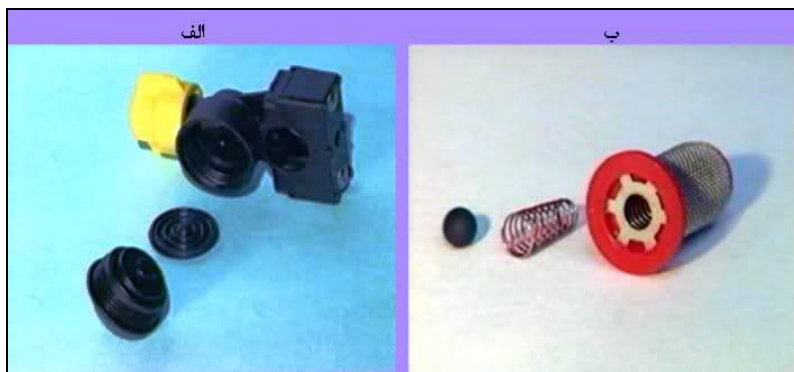
شکل ۱۷- الف: چک والو و ب: توری چکه گیر برای جلوگیری از چکیدن قطره‌های سم در هنگام قطع سمپاشی
