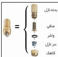
شکل ۲- نازل (افشانک) و اجزای داخلی آن
