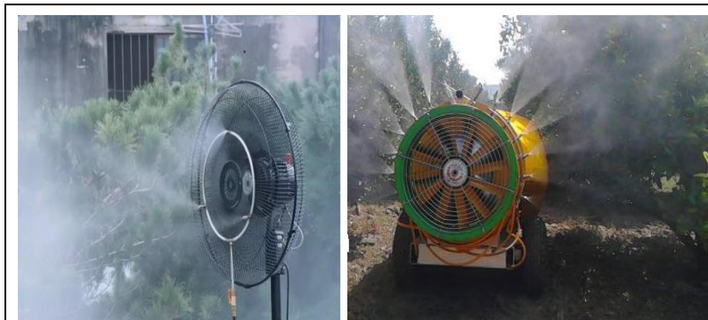
شکل ۲۰- نحوه تبدیل محلول سم به قطره‌های ریز توسط جریان شدید باد
