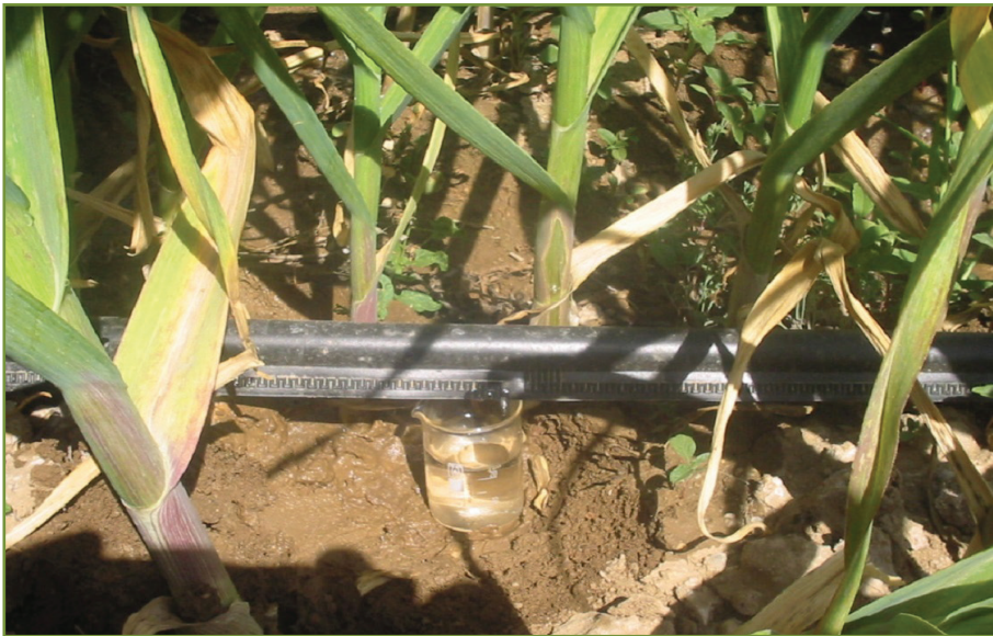
شکل ۱۲- اندازه‌گیری دبی قطره چکان‌ها در مزرعه سیر
