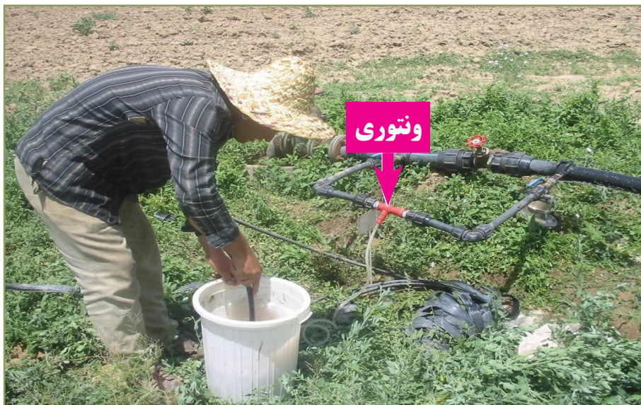
شکل ۷- استفاده از دستگاه ونتوری به منظور تزریق کود
