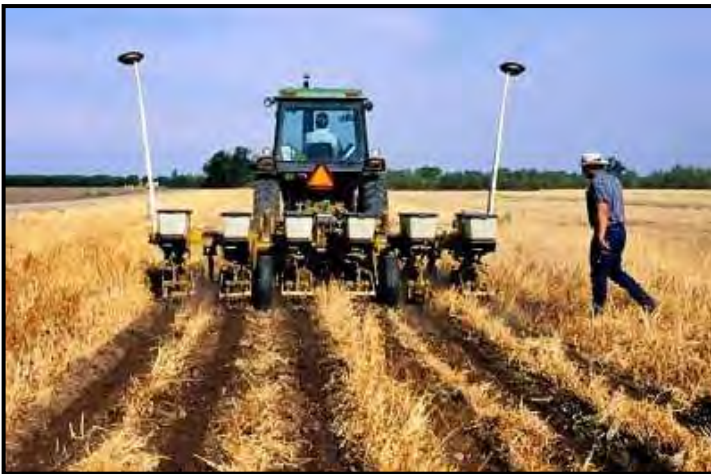
شکل ۵- کارنده‌هایی با منضمت خاک‌ورز برای کشت بر روی پشته.
