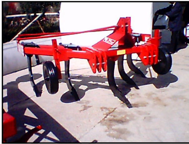
شکل ۴- زیرشکن ۵ شاخه با قاب V شکل و شاخه‌های C شکل
