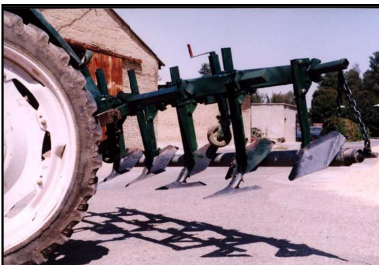
شکل ۴ - خاک ورز مرکب مورد استفاده در روش کاشت روی پشته‌های عریض
