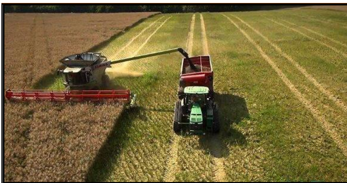
شکل ۹- حرکت چرخ تراکتور و تریلر حمل دانه در مسیر چرخ کمباین در مزرعه در روش استفاده از راهروهای ثابت
