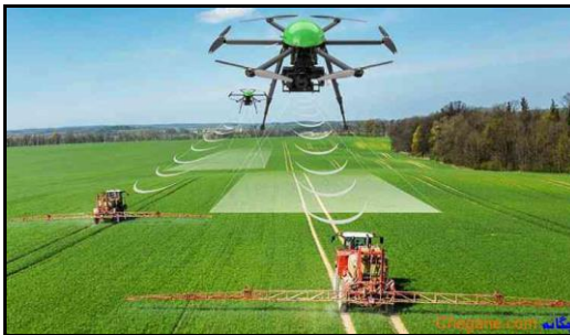
شکل ۱۲- هدایت ماشین‌ها در مزرعه بدون استفاده از راننده و به کمک ناوبری خودکار مجهز به سامانه موقعیت‌یاب جهانی (GPS)
