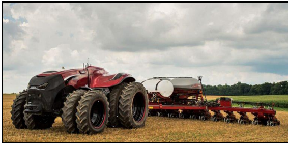
شکل ۱۱- هدایت ماشین‌ها در مزرعه بدون استفاده از راننده و به کمک سیستم ناوبری و هدایت خودکار مجهز به سامانه موقعیت‌یاب جهانی (GPS)
