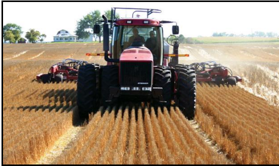
شکل ۳- استفاده از روش رفت و آمد در راهروهای ثابت برای انجام عملیات خاک‌ورزی و کاشت محصول جدید (حرکت چرخ تراکتور در مسیر چرخ کمباین محصول قبل)
