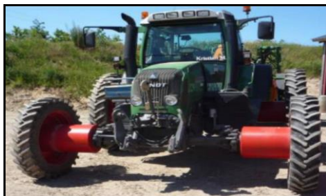
شکل ۱۳- افزایش فاصله چرخ‌های تراکتور با قرار دادن قطعات رابط برای افزایش طول اکسل چرخ
