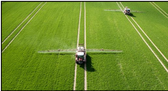
شکل ۴- استفاده از روش رفت و آمد در راهروهای ثابت برای انجام عملیات داشت (حرکت چرخ تراکتور در مسیر تردد ماشین‌های مورد استفاده در عملیات قبلی)
