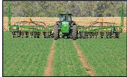
شکل ۵- استفاده از روش رفت و آمد در راهروهای ثابت برای انجام عملیات داشت (حرکت چرخ تراکتور در مسیر تردد ماشین‌های قبلی)
