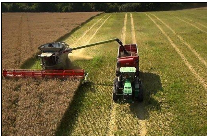
شکل ۶- استفاده از روش رفت و آمد در راهروهای ثابت برای انجام عملیات برداشت (حرکت چرخ تراکتور و تریلر حمل دانه در مسیر تردد کمباین در مزرعه)
