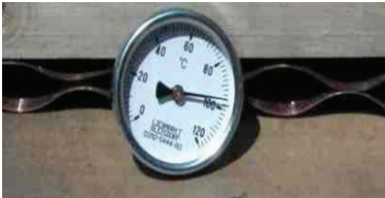
شکل ۱۶- اندازه گیری دمای یک جمع کننده خورشیدی
