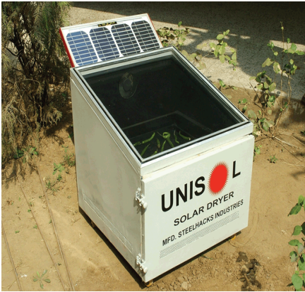
شکل ۱۳- کاربرد سلول های خورشیدی (PV) در خشک کن های خورشیدی
