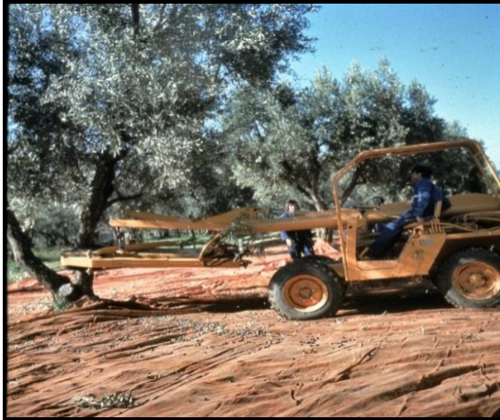
شکل ۱- تکاننده تنه در حین برداشت میوه زیتون
