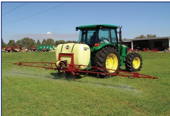
شکل ۱۸- سم‌پاش میکرونر پشت تراکتوری
