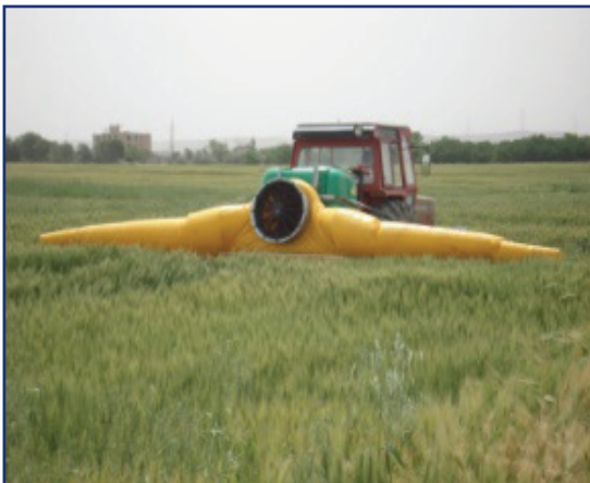
شکل ۱۷- سم‌پاش بوم‌دار پشت‌تراکتوری هواکمک
