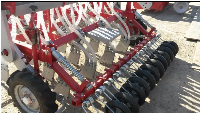
شکل ۱۱- آرایش قرارگیری شیاربازکن‌ها روی سه تیرک در شاسی دستگاه کارنده
