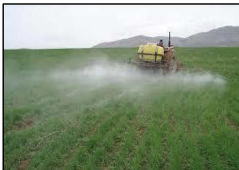
شکل ۳- بادبردگی قطرات سم
