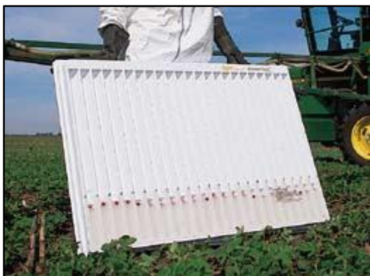
شکل ۱۸- یکنواخت نبودن پاشش در طول تیر افشانک
