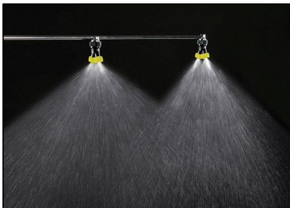
شکل ۸- نامناسب بودن الگوی پاشش سم (متفاوت بودن زاویه پاشش دو افشانک مجاور هم؛ زاویه پاشش در افشانک سمت راست ۸۰ درجه و در افشانک سمت چپ ۱۱۰ درجه است).
