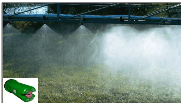
شکل ۹- فرسودگی افشانک‌ها (دو افشانک سمت راست تیر افشانک گشاد شده است)
