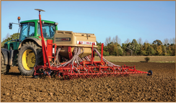
شکل ۹۵- ماشین کشت مستقیم در حال کار
