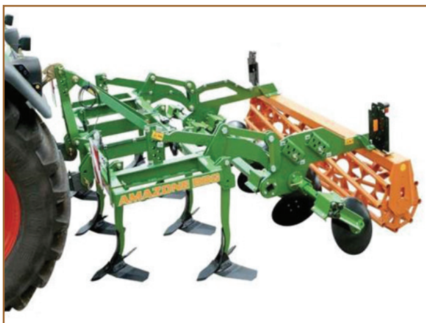
شکل ۸۳- گاوآهن قلمی (چیزل) همراه با بشقاب‌ها و غلتک خردکننده کلوخ (خاک‌ورز مرکب یا چیزل پکر)
