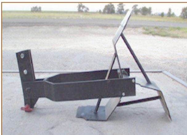
شکل ۱۴- یک واحد از شیاریبند پارویی و اجزای آن
