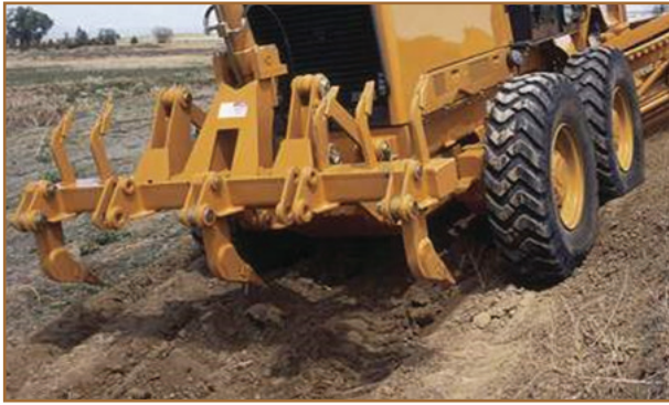
شکل ۸۹- ریپر سوار بر عقب بولدوزر
