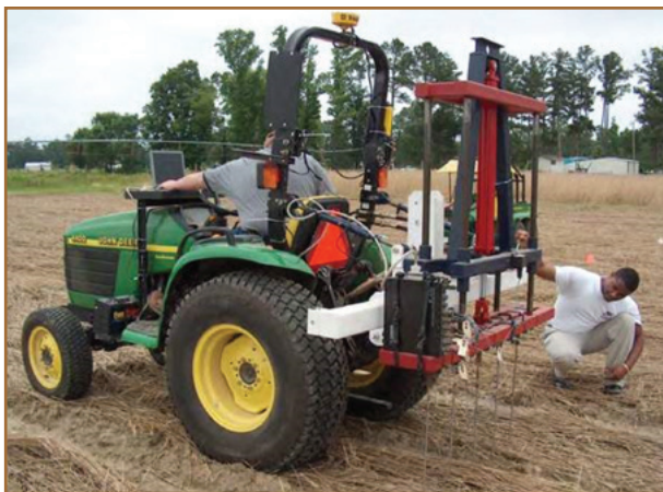
شکل ۷۹- نفوذسنج مخروطی تراکتوری
