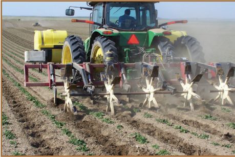
شکل ۳۳- ماشین خاک‌ورز مخزنی مجهز به جک هیدرولیکی
