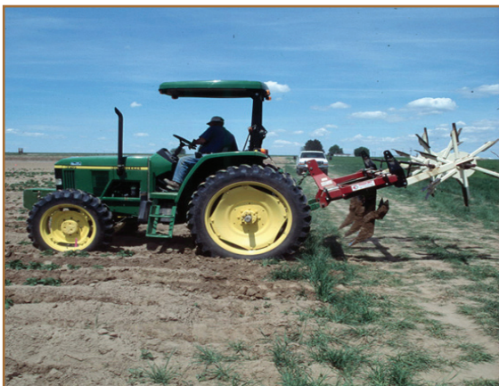
شکل ۲۲- افزودن ماشین خاک‌ورز مخزنی به خاک‌ورز اصلی
