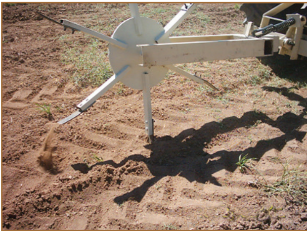
شکل ۳۲- خاک‌ورز مخزنی مجهز به فنر شناوری
