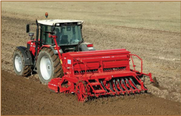
شکل ۹۲- کمبینات (ماشین خاک‌ورزی - کشت) در حال کار
