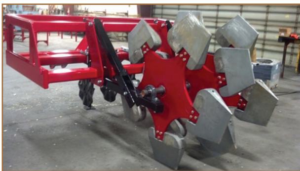
شکل ۳۵- گوه‌های ماشین خاک‌ورز مخزنی فشاری
