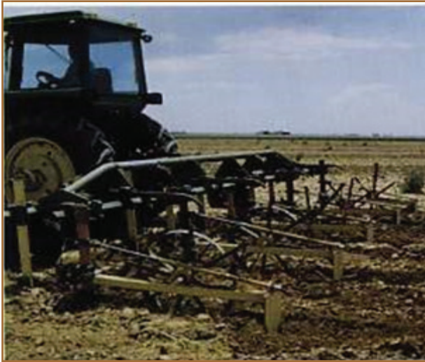
شکل ۱۵- شیاربند بیلچه‌ای مکانیکی در حال کار
