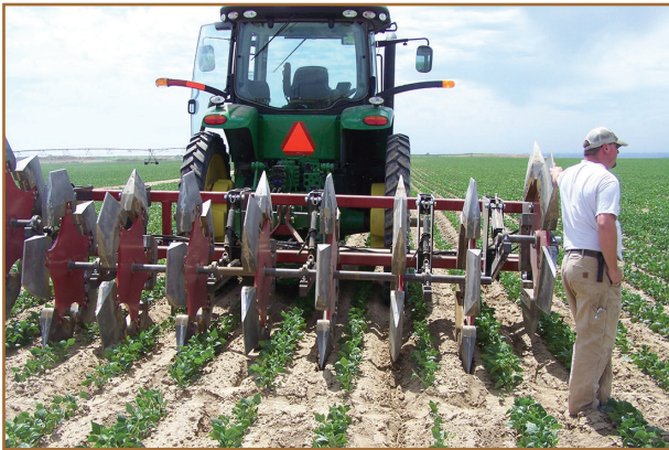
شکل ۲۹- ماشین خاک‌ورز مخزنی ضربه‌ای
