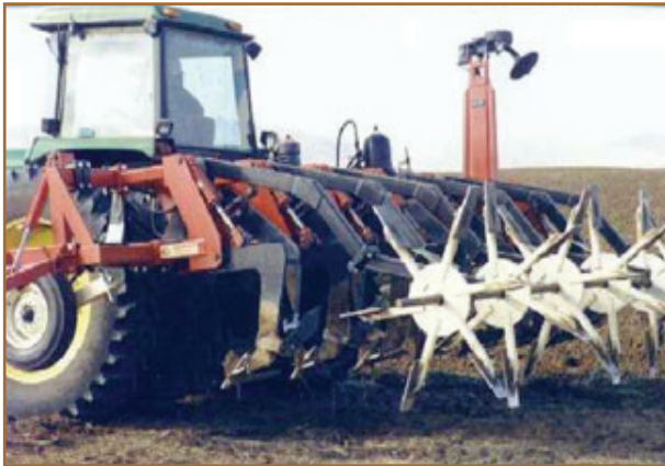
شکل ۲۷- ماشین خاک‌ورز مخزنی عنکبوتی
