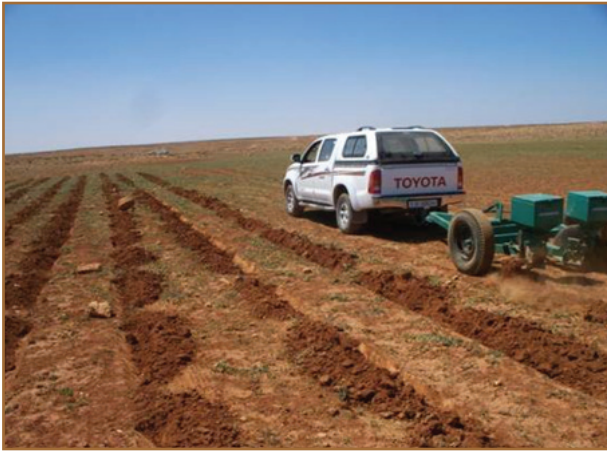
شکل ۵۶- پیتر بشقابی قابل اتصال به انواع خودرو در حال کار به انضمام کارنده بذر گیاه مرتعی
