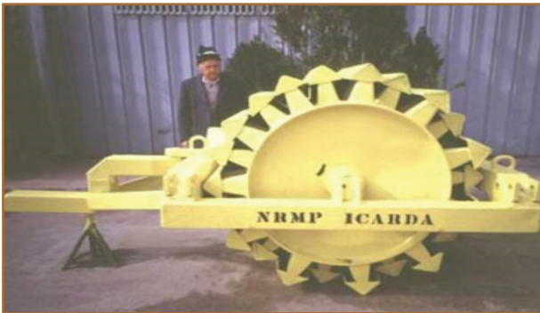
شکل ۴۵- نقش‌بند پشت تراکتوری ساخته شده توسط مؤسسه بین‌المللی ایکاردا
