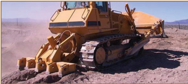
شکل ۸۸- شکستن لایه سخت خاک با ریپر
