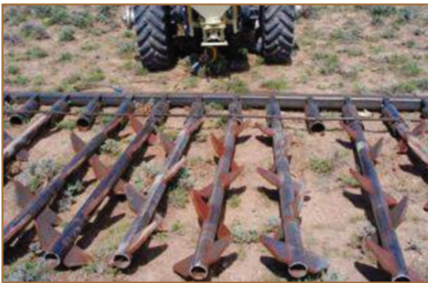
شکل ۷۴- ایجاد خراش در سطح خاک به‌منظور افزایش نفوذ آب
