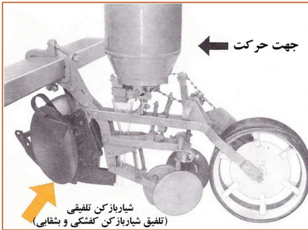
شکل ۲۰- شیاربازکن تلفیقی (تلفیق شیاربازکن کفشکی و بشقابی)
