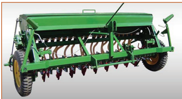
شکل ۶۳- خطی کار مجهز به دو چرخ انتهایی
