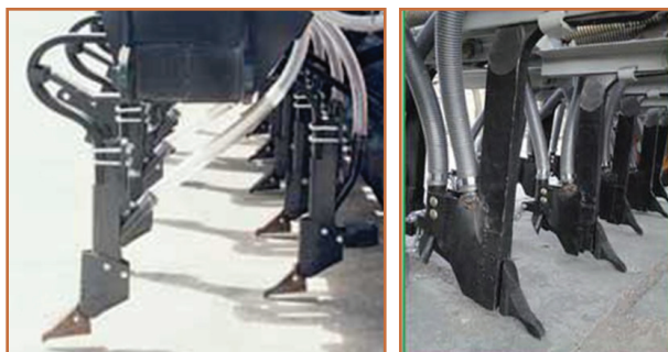
شکل ۷۵- انواع شیار بازکن بیلچه‌ای
