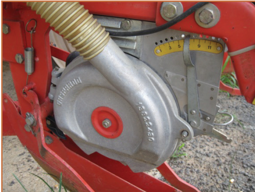
شکل ۲۱- دستگاه اندازه‌گیری (سنجش) بذر (مقسم یا موزع)
