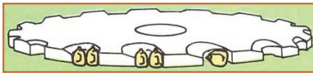
ج- اندازه حفره ها خیلی بزرگ تر از اندازه بذر است (اندازه حفره ها نامناسب است)
