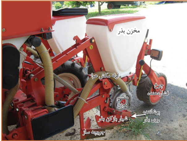
شکل ۳- قسمت های مختلف یک کارنده
