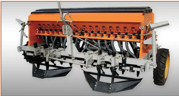
شکل ۴۸ - خطی‌کار مخصوص اراضی شور
