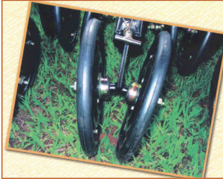
شکل ۷۹- انواع چرخ فشار
