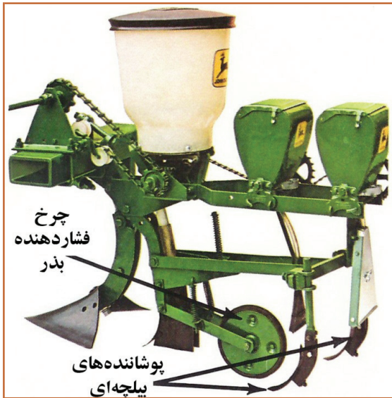
شکل ۳۳- پوشاننده بیلچه‌ای و چرخ فشاردهنده بذر
