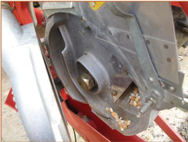
شکل ۲۲- قسمت های داخلی یک موزع پنوماتیکی
