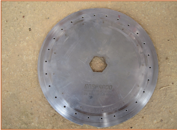
شکل ۲۳- صفحه بذر در ردیف کارهای پنوتیکی
