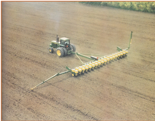
شکل ۱۰- ردیفکار پنوماتیکی (بادی) هجده ردیفه
