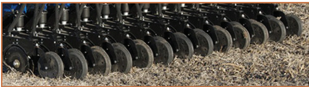
شکل ۶۲- انواع مختلف چرخ فشاردهنده
