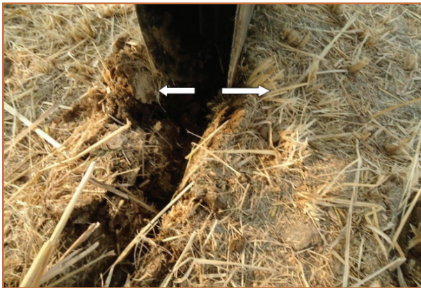
شکل ۷۴- شیاربازکن دو دیسکی ساده
