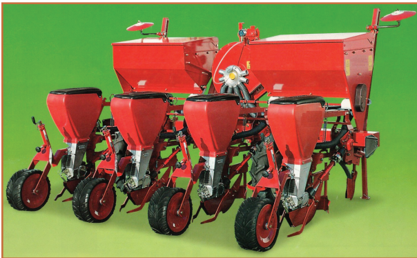
شکل ۸- ردیف کار پنوماتیکی (بادی) چهار ردیفه
