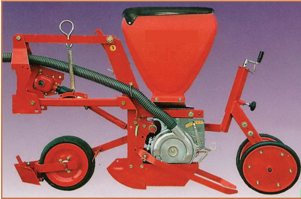
شکل ۱۲- یک واحد کارنده در ردیف کارها
