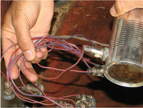
شکل ۸- اتصال ترمومتر قوطی به سیم های رابط پتانسیومتر
