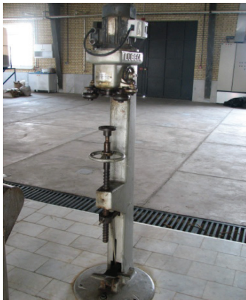
شکل ۲- درب بندی قوطی های آگزاست شده با دستگاه دوخت دوبل نیمه اتوماتیک
