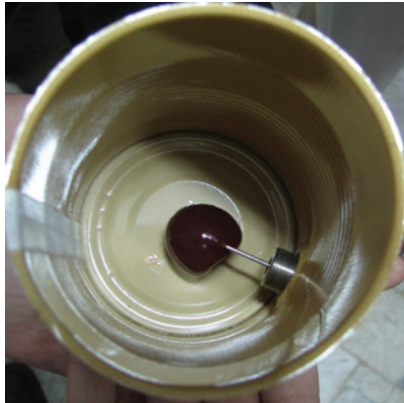
شکل ۶- میوه قرار داده شده در نوک ترموکوپل کنستانتین مس سوزنی برای اندازه گیری نفوذ حرارتی در میوه
