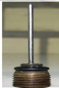
شکل ۵- ترموکوپل کنستانتین مس سوزنی نصب شده در یک دهم ارتفاع قوطی های A1 Tall برای اندازه گیری نفوذ حرارتی
