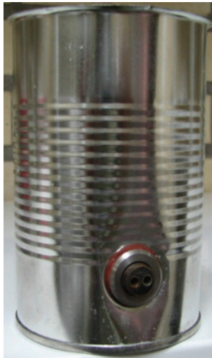
شکل ۷- ترموکوپل کنستانتین مس سوزنی نصب شده در قوطی های A1Tall برای اندازه گیری نفوذ حرارتی
