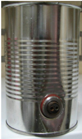
شکل ۴- ترموکوپل سوزنی کنستانتین مس آماده نصب در قوطی A1Tall مقاوم به اسید با لاک LR مخصوص
