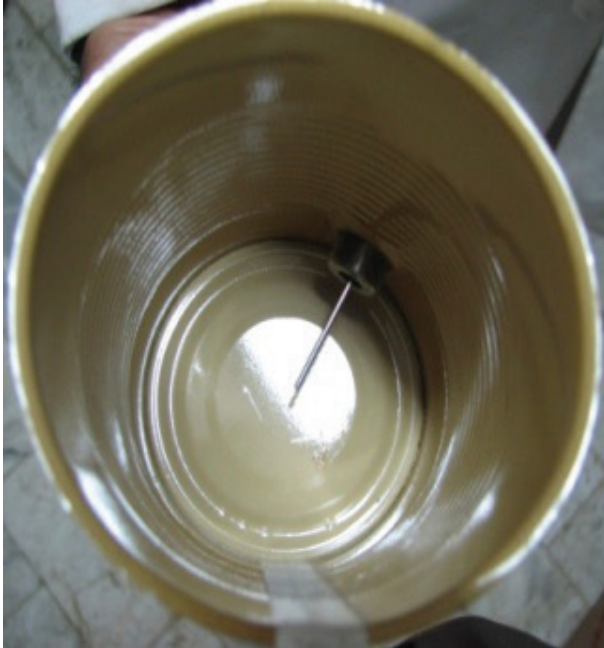
شکل ۳- ترموکوپل کنستانتین مس نصب شده در قوطی های A1Tall برای اندازه گیری نفوذ حرارتی
