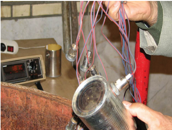
شکل ۱۱- سامانه اندازه گیری حرارتی قبل از قراردادن در اتوکلاو
