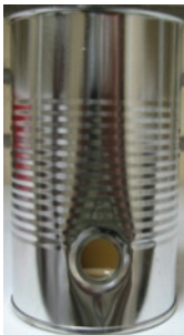
شکل ۵- ترموکوپل کنستانتین مس سوزنی نصب شده در یک دهم ارتفاع قوطی های A1 Tall برای اندازه گیری نفوذ حرارتی
