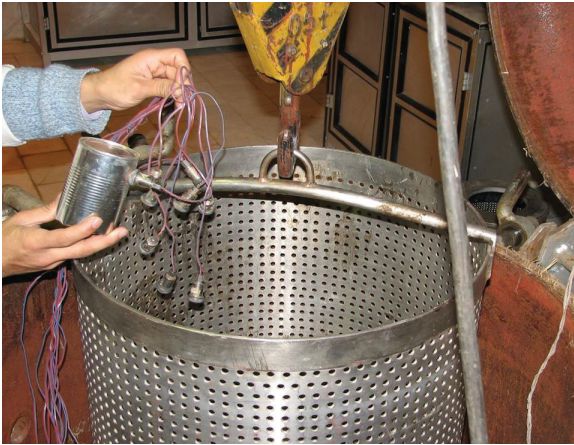
شکل ۱۲- سامانه اندازه گیری حرارتی قوطی متصل به ترموکوپل و آماده قرار گرفتن در سبد اتوکلاو
