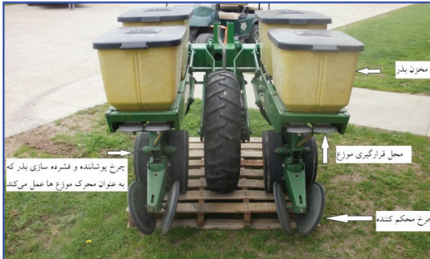
شکل ۱۲- ردیف‌کار و اجزاء آن
