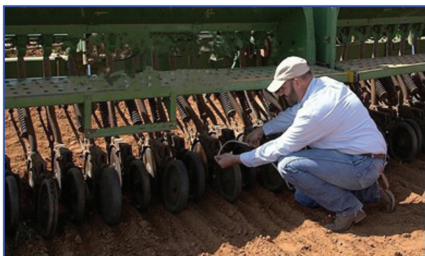
شکل ۱۱- کالیبراسیون خطی کار در مزرعه
