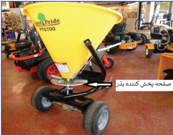
شکل ۴ - بذرپاش گریز از مرکز مجهز به پخش‌کننده صفحه‌ای
