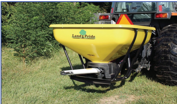
شکل ۵ - بذرپاش مجهز به پخش‌کننده لوله‌ای نوسانی
