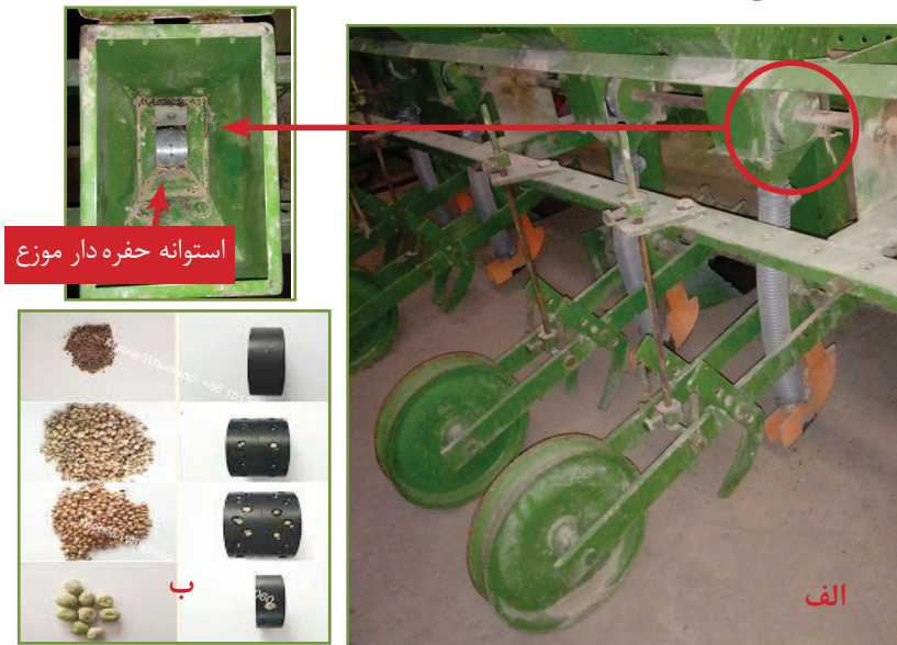
شکل ۱۲- (الف) دقیق‌کار مکانیکی ریزدانه‌کار، (ب) استوانه‌های حفره‌دار موزع برای بذور در اندازه‌های مختلف
