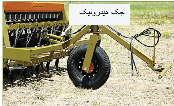
شکل ۷- روش تنظیم عمق کاشت بذرها به‌صورت دستی و هیدرولیکی
