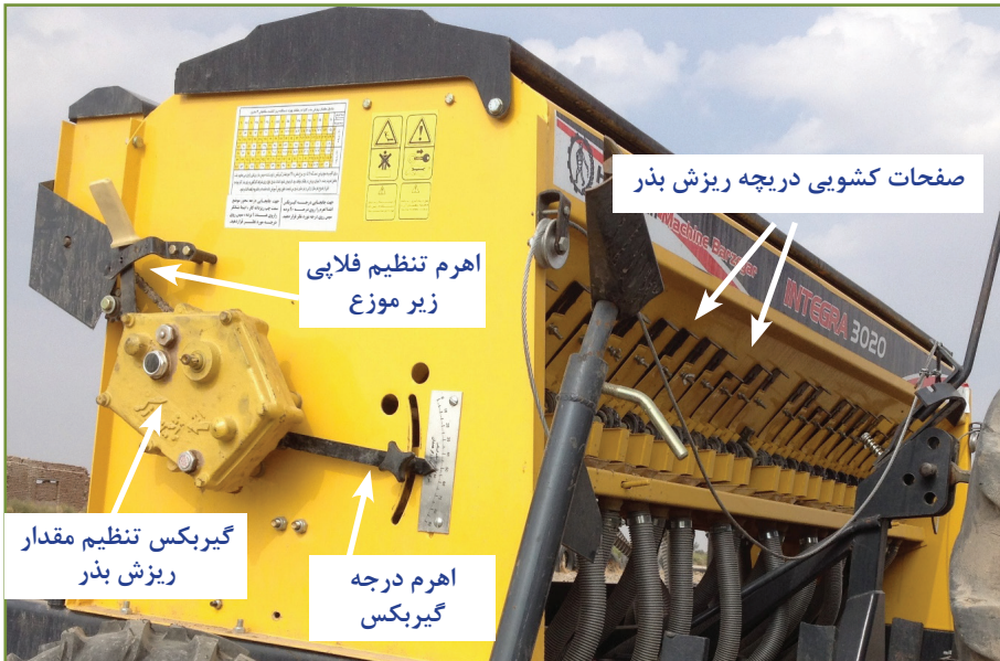
شکل ۱۰- اجزای خطی کار غلات برای تنظیم میزان بذر و کود مصرفی (کالیبراسیون)
