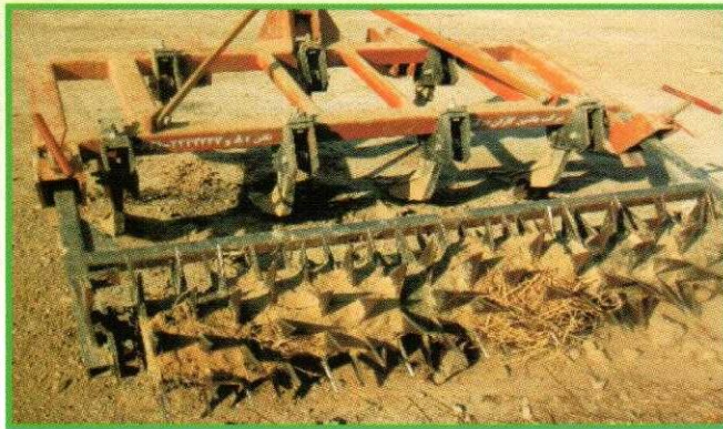
شکل ۹- گیر کردن گل و بقایا در غلتک چیزل-پیلر در خاک مرطوب
