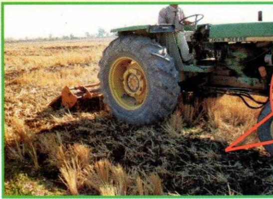
شکل ۱۰ - گاواهن دوار یا روتیواتور در حال کار در بقایای برنج
