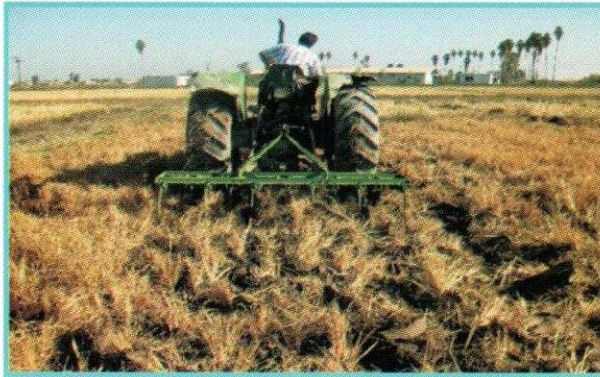
شکل ۷- گاوا آهن قلمی در حال شخم زدن زمین پوشیده از بقایای برنج
