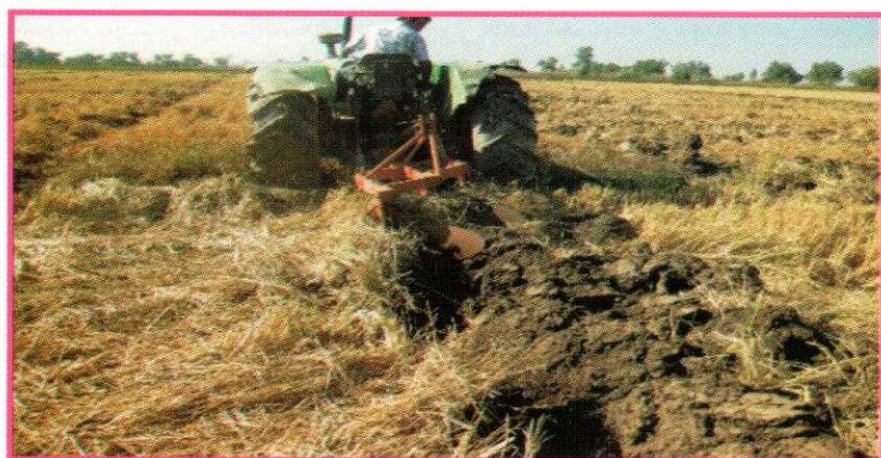
شکل ۲- اجرای عملیات تهیه زمین با گاو آهن برگردان دار در بقایای برنج
