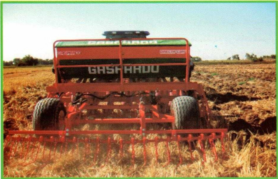
شکل ۱۵ - کارنده کشت مستقیم گاسپاردو در حال کشت بذر گندم به همراه کود پایه در بقایای برنج
