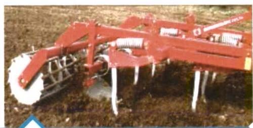
دارای کیفیت بالاتری نسبت به خاک ورزهای ساده است، اما به علت سنگینی دستگاه های مرکب و طول بیشتر آن ها، نیاز به تراکتور بزرگتر با توان بیشتری برای کشیدن دارند.
