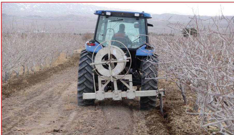
شکل ۳- مراحل حفاری و کارگزاری همزمان لوله‌های آبده در باغ‌های پسته
