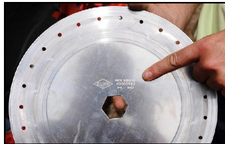
شکل ۱۸- تعیین تعداد سوراخ‌های صفحه بذر
