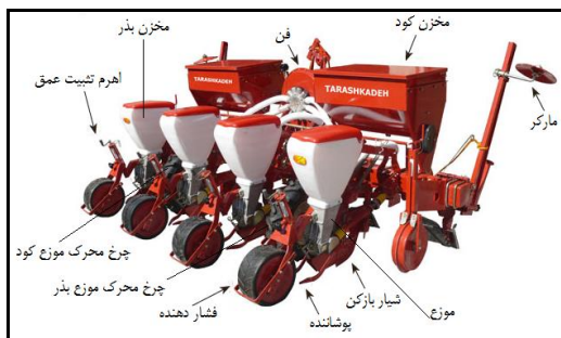
شکل ۴ - اجزای ردیف کار پنوماتیکی
