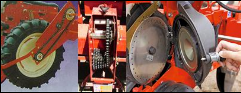
شکل ۲۰ - چرخ محرک - جعبه دنده - صفحه بذر
