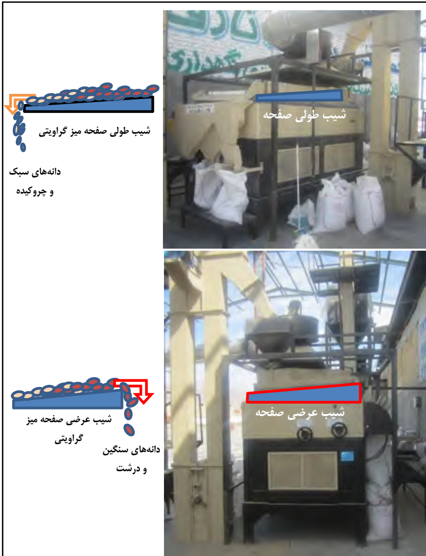
شکل ۱۱- تغییرات زاویه‌های طولی و عرضی صفحه میز گراویتی (بی نام، ۱۳۹۵)
