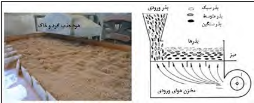
شکل ۳- شناورسازی دانه‌ها در دستگاه جداساز وزنی (میز گراویتی) (تصویر از نگارنده)
