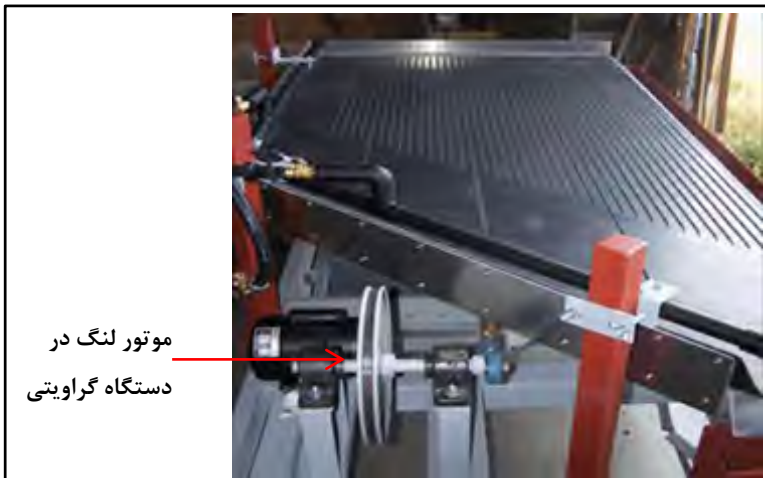
شکل ۱۵ - موتور لنگ خارج از مرکز برای ارتعاش میز گراویتی (تصویر از نگارنده)
