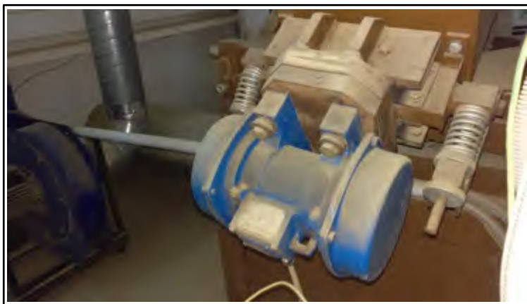
شکل ۸- یک نمونه از موتورهای ارتعاشی مورد استفاده در میزهای گراویتی (تصویر از نگارنده)
