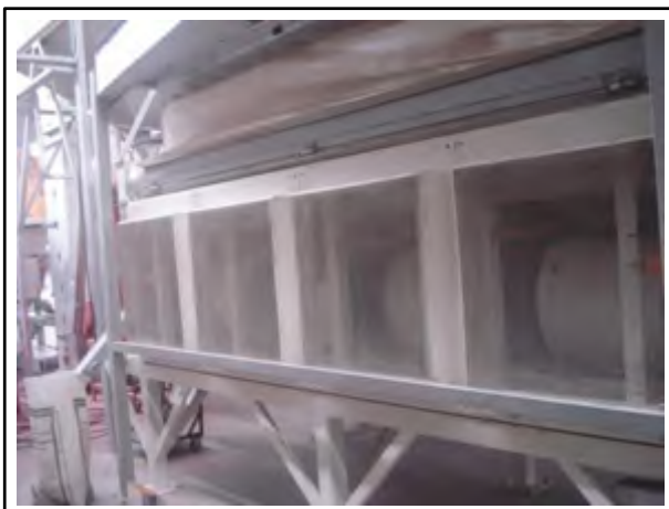
شکل ۱۴- دریچه‌های ورودی هوا به فن‌های هوادهی دستگاه گراویتی (تصویر از نگارنده)
