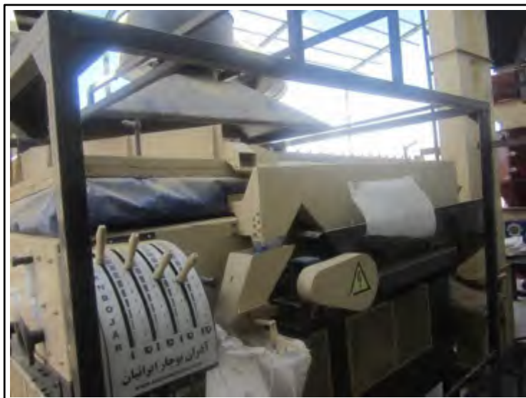
شکل ۹- اهرم‌های کنترل دریچه‌های جریان هوا در دستگاه گراویتی (بی نام، ۱۳۹۵)
