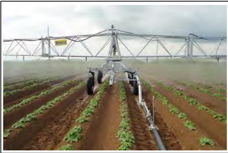
شکل ۶- نمونه‌ای از بوم اسپری ماشین آبیاری قرقره‌ای
