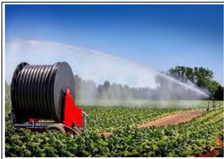
شکل ۳- ماشین آبیاری آفشان قرقره‌ای در حال آبیاری با آبپاش تفنگی
