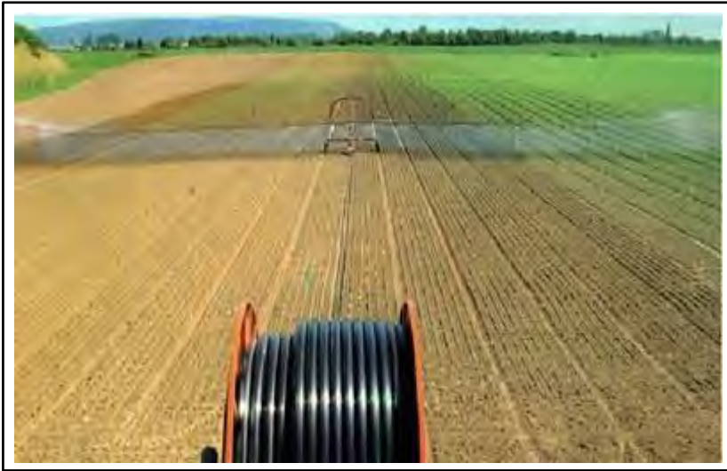
شکل ۲- نمونه‌ای از ارابه دستگاه آبیاری قرقره‌ای همراه با بوم اسپری
