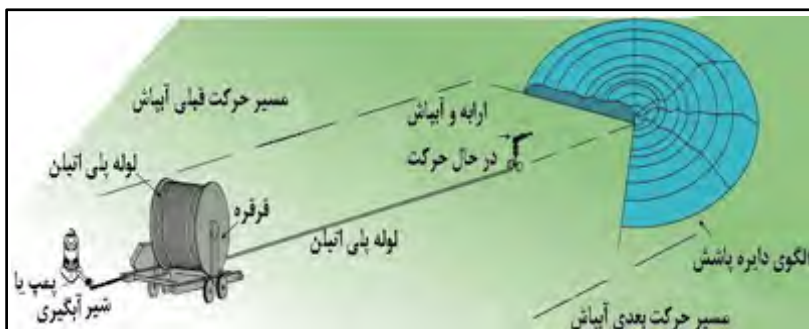
شکل ۱- نمای کلی یک دستگاه آبیاری قرقه‌ای (شیلنگ پیچ)
