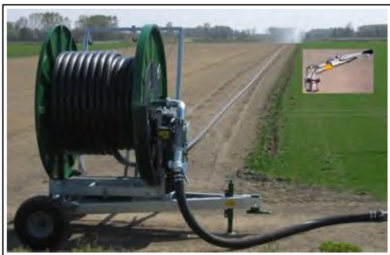
شکل ۵- ماشین آبیاری قرقه‌ای، ارابه و آبیاش تفنگی در حال کار
