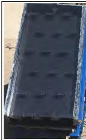
شکل ۷- صفحه جاذب با تیغه های بادگیر
