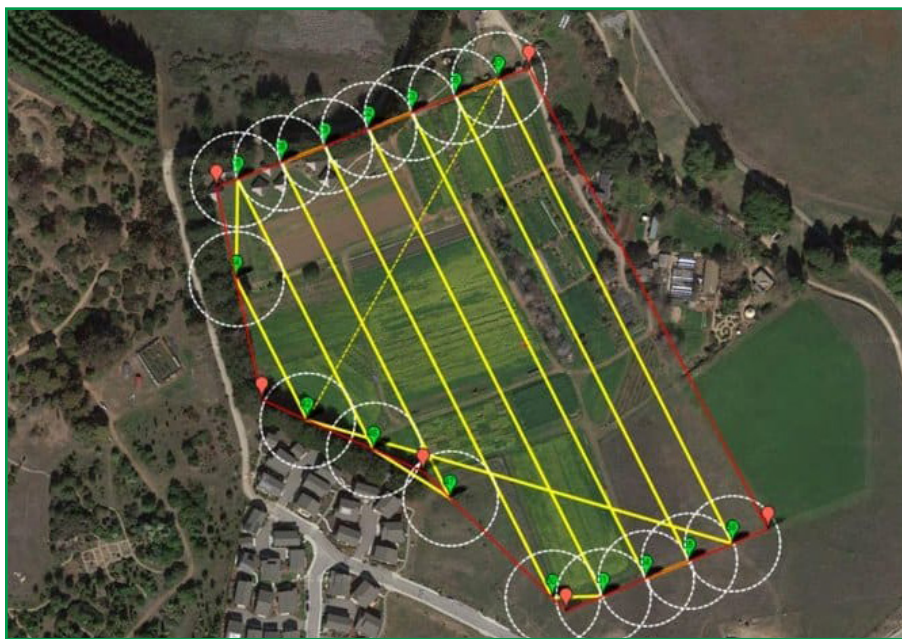
شکل ۱۳- سامانه اتوپیلوت در پهپاد سم‌پاش
